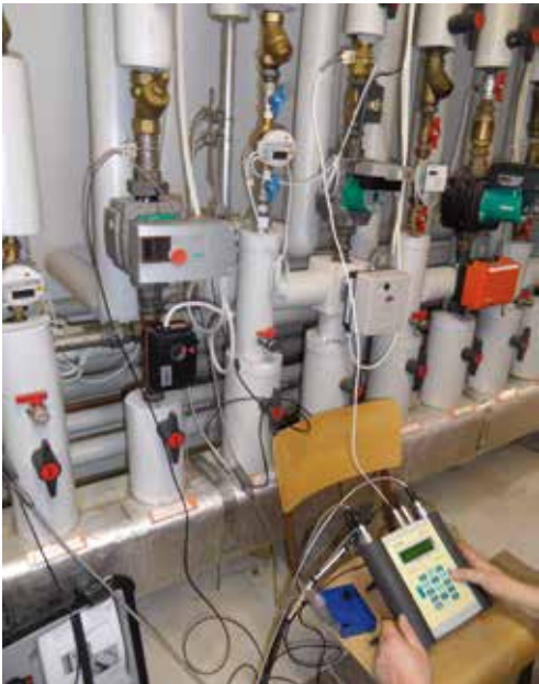
Abb. 23: Datenerfassung mittels Ultraschall-Durchflussmesser
